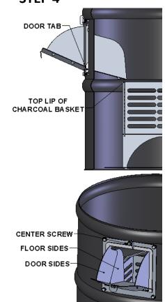
BEND FLOOR OUT OF MOUNTING BEZEL, AS SHOWN. PEEL & STICK THE GASKET AROUND 3 SIDES OF BEZEL OPENING. (HALF OF GASKET ON FRONT SIDE, THE OTHER HALF ON BACK SIDE.) PEEL & STICK ANOTHER FLAT GASKET ACROSS LOWER BACK SIDE OF BEZEL. INSERT FLOOR SIDE PANELS INTO SLOTS OF FLOOR AND TWIST THE TABS (4) TO ATTACH.
